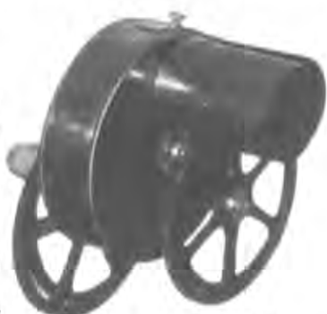
بېككېرېل تەجرىبە - تەتقىقاتتا ئىشلەتكەن فوسفور نۇرى رادىئاتسىيە ئەسۋابى.
