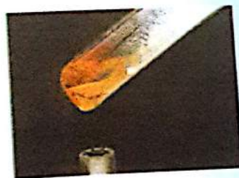
3.5 - رەسىم. سىماب ئوكسىدنىڭ ئىسسىقلىق تەسىرىدە پارچىلىنىشى
