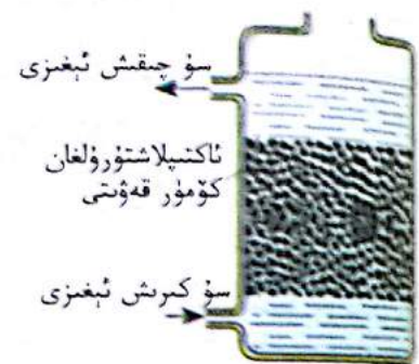
18.3 - رەسىم. ئاكتىپلاشتۇرۇلغان كۆمۈر قەۋىتى سۇ كىرىش ئېغىزى، ئاكتىپلاشتۇرۇلغان كۆمۈر قەۋىتى، سۇ چىقىش ئېغىزى.
